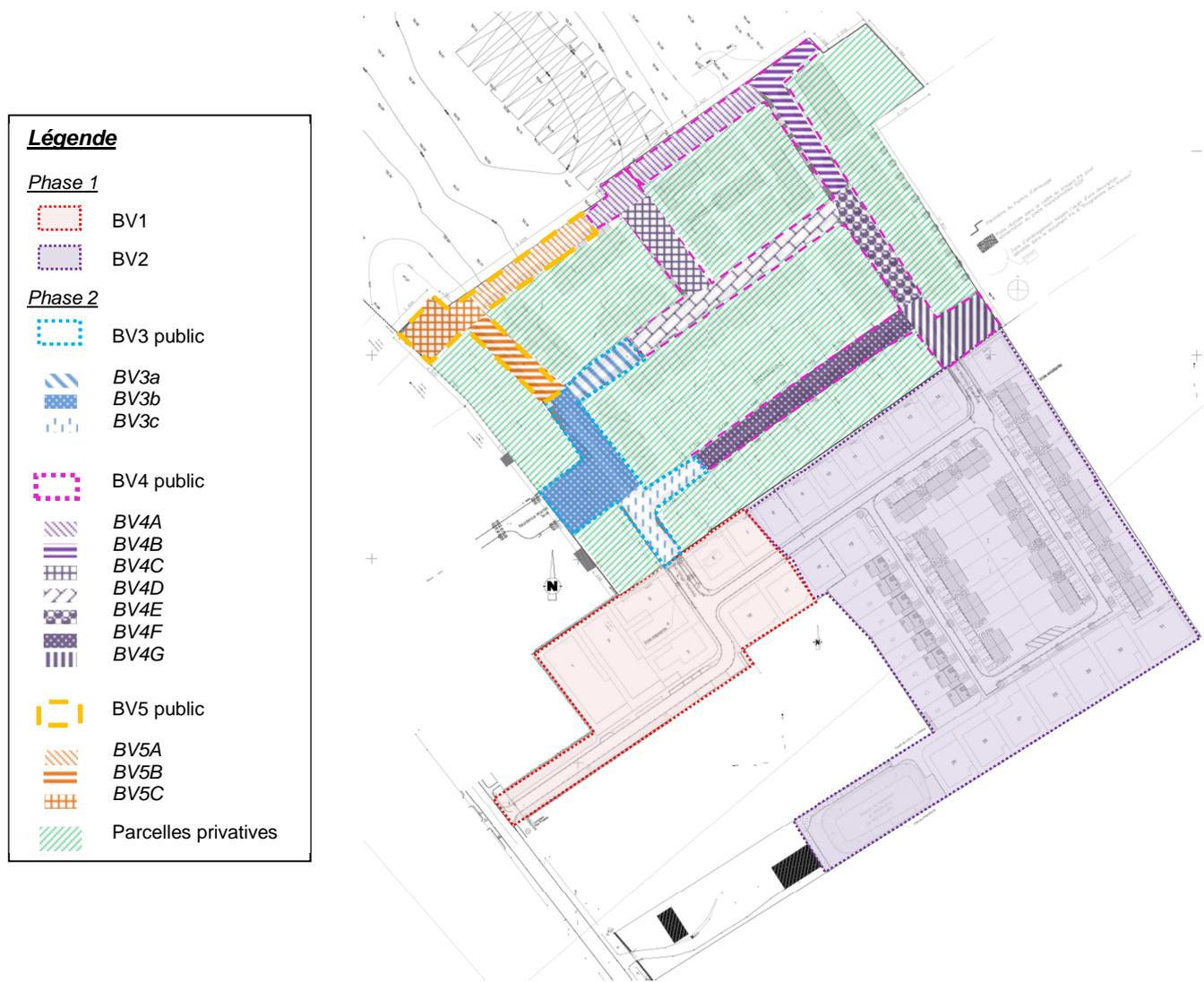
Figure 5 : Identification des sous-bassins versants des phases 3, 4 et 5
